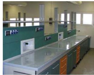
I PIANI DI LAVORO IN ACCIAIO PORCELLANATO SONO PROVVISI DI RISVOLTI PERIMETRALI ANTIDEBORDANTI<sup>(1)</sup> STAMPATI E RIGAVATI DA SPECIALE ACCIAIO DECARBURATO SPESSORE 12/10, PORCELLANATI CON SMALTI ACIDO RESISTENTI DI CLASSE "AA" IN CONFORMITÀ ALLE NORME DEL SETTORE E SOTTOPOSTI A DOPPIA COTTURA IN FORNI SPECIALI A 820° C.
